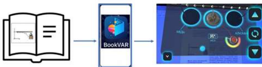
Рис. 2. Технологія відтворення AR за допомогою зображень-маркерів
